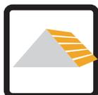
*Instalación perpendicular a la pendiente,* panel REXOLATTE sin contralistones colocado sobre cabios o patas de caballete. Es conveniente realizar un contralistonado para crear la ventilación del bajotejado y, después, montar los listones y la cubierta.
