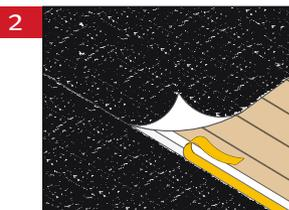
2- Desenrollar el siguiente rollo con solapa de 100 mm por encima del espacio libre de filamentos del primer rollo. Fijar la lámina en situ.
