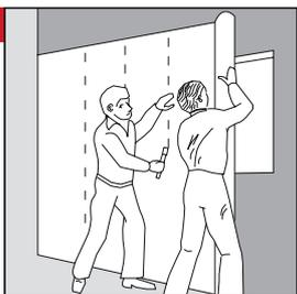
2- Cubrir ventanas y puertas con Tyvek® mientras se envuelve la pared de la casa, e ir grapando a la vez, solapando 150 mm cuando se empalmen 2 rollos. Una persona va desenrollando, la otra va grapando.
