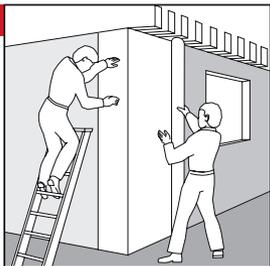
1- Comenzando a 30 cm de una esquina, desenrollar Tyvek® y continuar hasta envolver completamente la pared de la casa.
